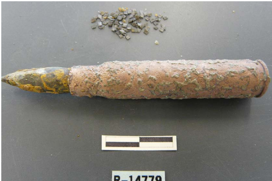
Fig.60 Detall d'un cartutx de Mauser 7,92x57, amb la bala i la pólvora. Autor: Àbac
